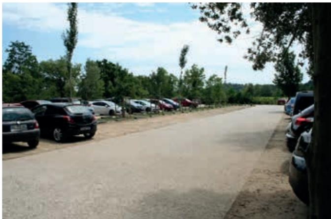
**Chaussée véhicules en béton de sol désactivé et emplacements de stationnement en tout-venant compacté**
