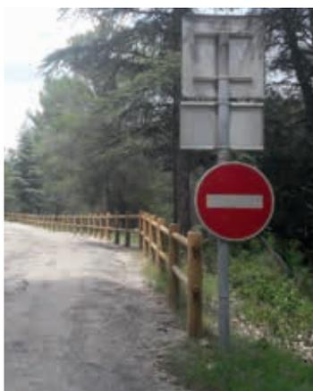
Les supports des panneaux pourront sur les espaces parkings, être sur support métallique de modèle standard ou sur poteau ou potelet bois. Les panneaux bas seront à installer à l'écart des risques de chocs par les véhicules.
