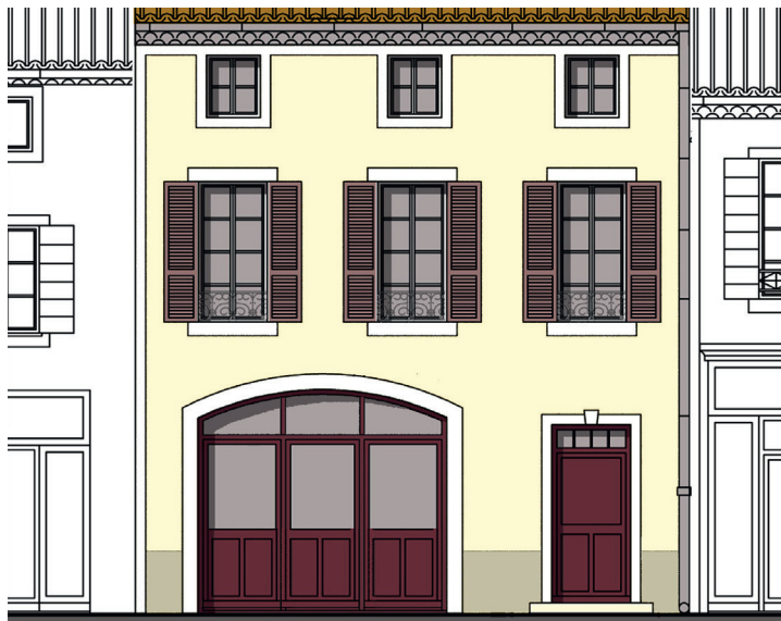
Le portail a été transformé suite à la création d'une pièce de vie. L'ensemble menuisé bois s'inspire d'une ancienne échoppe.
