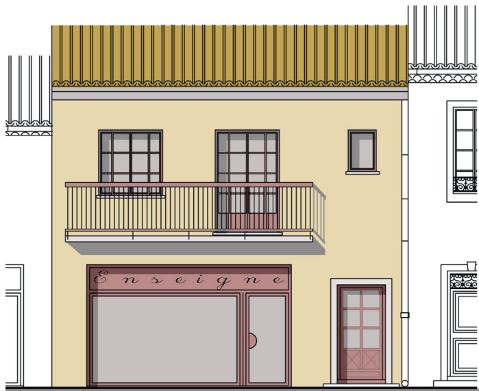
Transformation d'un garage en commerce, en conservant les proportions d'origine.
