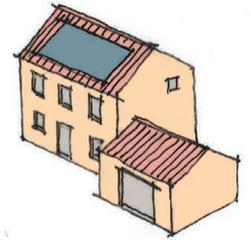
Les toitures 4 pentes, en plus du fait qu'elles ne correspondent que très peu aux registres des toitures locales et rendent difficiles les extensions, sont particulièrement inadaptées à l'installation de panneaux.
